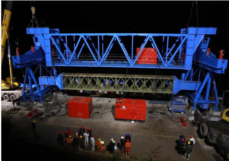
图 1 跨缆吊机荷载模拟试验
