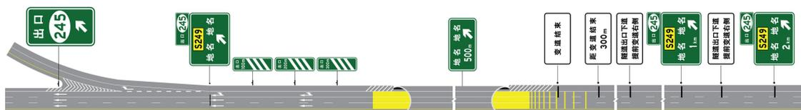
图 4 下道车辆提前完成向右变道且不可分配专用车道时标志和标线设置示例
