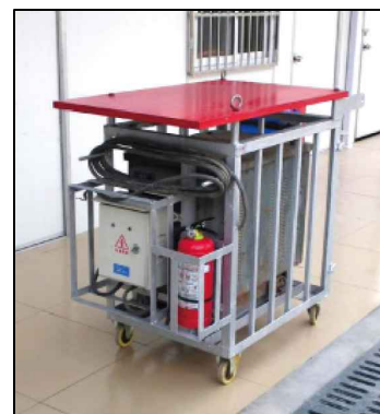
电焊机推车（移动）示例
