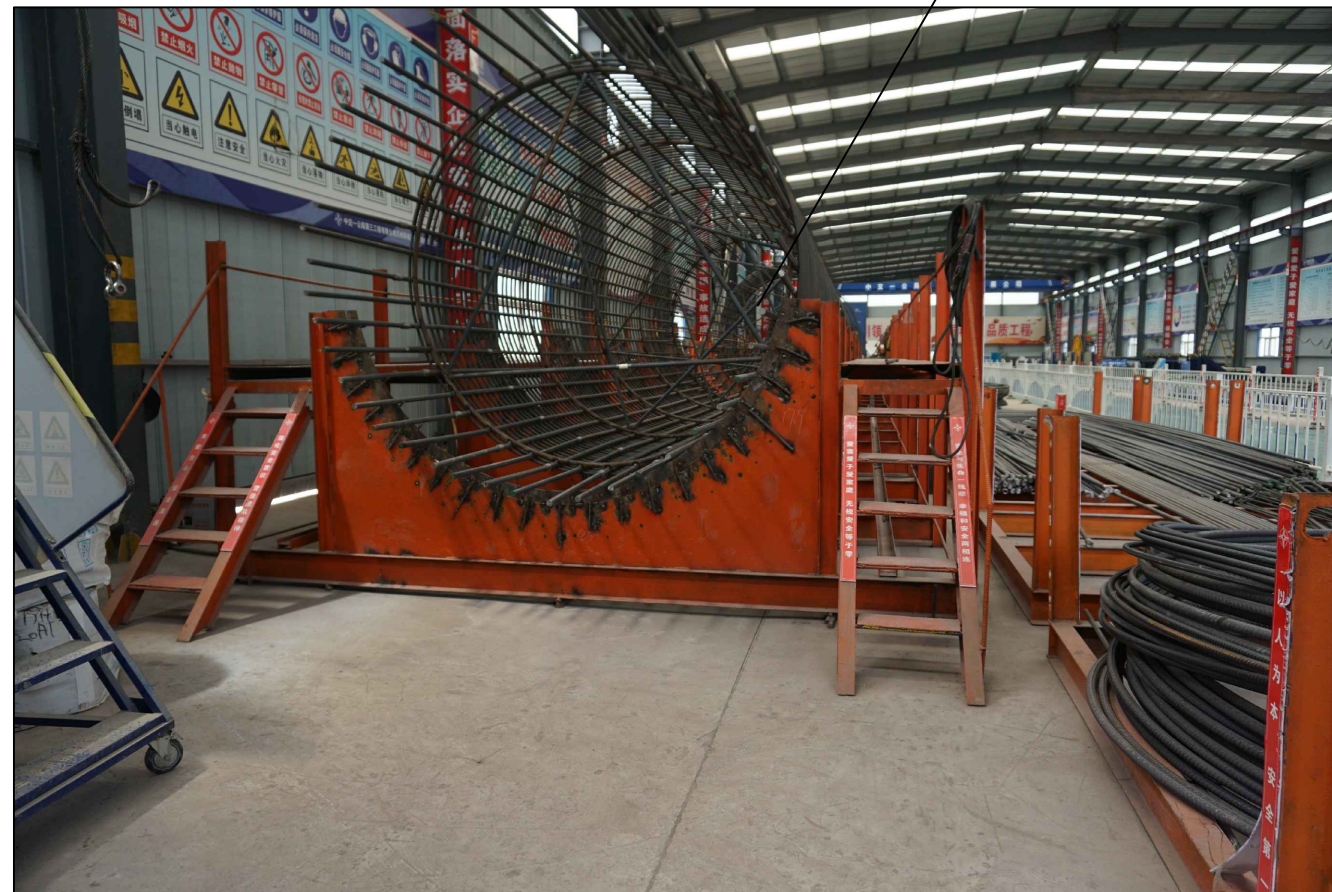
钢筋笼支撑架示例
