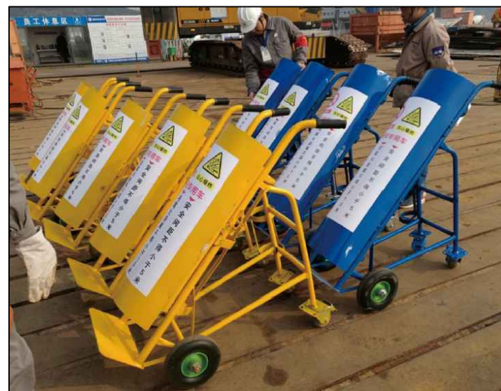
氧气（乙炔）瓶推车示例
