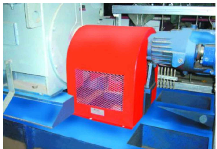
电机联轴器防护罩示例
